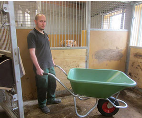
Extra modifiziert: Gestell verzinkt, Laufrad pannensicher
