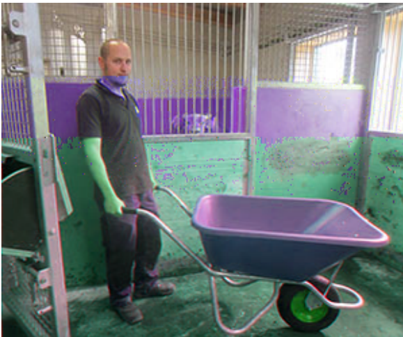
Extra modifiziert: Gestell verzinkt, Laufrad pannensicher
